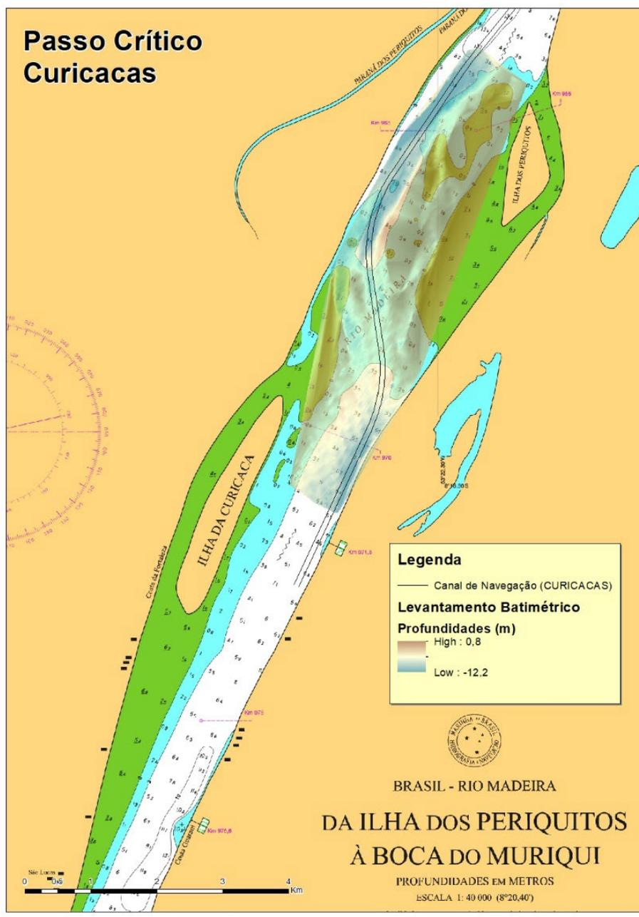
**Figura 3 - Passo Crítico Curicacas (levantamento batimétrico de novembro/2019) com a Carta Náutica nº 4750 – Ilhas dos Periquitos à Boca do Muriqui.**
